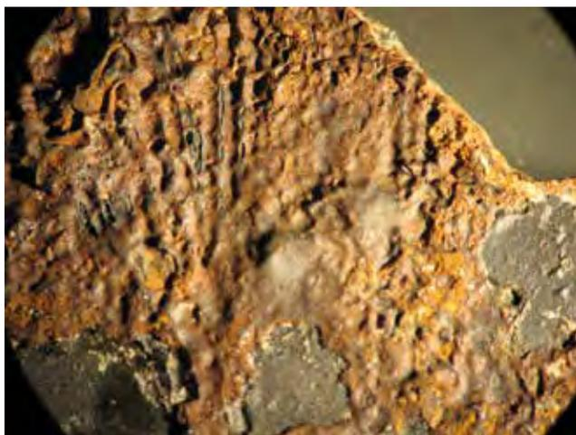
Fig. 7. Recuperación de la capa de magnetita en una lámina de hierro mediante la limpieza con microabrasímetro. El aspecto de la superficie recuperada es muy bueno y permite hacerse una idea muy ajustada de lo que fue la superficie original de estas piezas de armamento.
