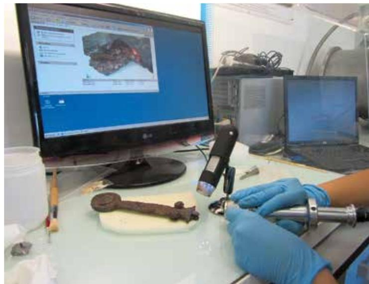
Fig. 5. Desarrollo del trabajo con el equipo LASER del SECYR mediante un protocolo de transmisión indirecta por microcámara (40X) y visionado en pantalla de plasma de alta resolución. El trabajo se efectúa bajo una campana de extracción estanca para aumentar la seguridad y evitar al técnico los potenciales productos vaporizados.
