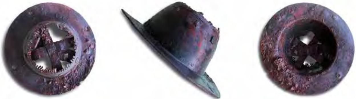
Fig. 18. Diferentes vistas del umbo del escudo de la T109 después de que el trabajo de restauración con láser haya permitido recuperar gran parte de la magnetita formada durante el enterramiento.
