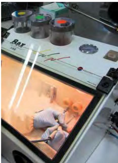
Fig. 6. Imagen que recoge un momento de trabajo de intervención con microabrasímetro con microesferas de aluminio en una pieza de hierro, realizado en la cámara de trabajo.
