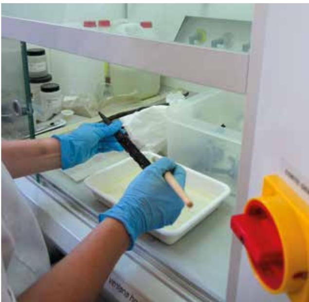
Fig. 14. Aplicación de BTA sobre una de las piezas de hierro de *Pintia*, dentro de una campana de extracción de gases que garantiza la seguridad del personal técnico.
