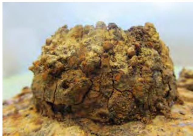
Fig. 3. Aspecto del aumento dimensional generado por el desarrollo de la corrosión en la *caetra* de la T107, que llega a producir grietas y fisuras de dimensiones considerables.
